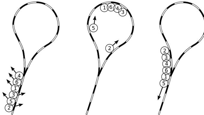
Состав сортируется следующим образом. Сперва он подгоняется хвостом к развилке, после чего последний вагон отцепляется и заводится в тупик. Все остальные вагоны по очереди отцепляют и заводят в тупик по одному из двух путей, присоединяя его либо к голове, либо к хвосту формируемого в тупике состава. Когда все вагоны заведены в «ракетку», сформированный состав целиком выводят оттуда головой вперёд.
